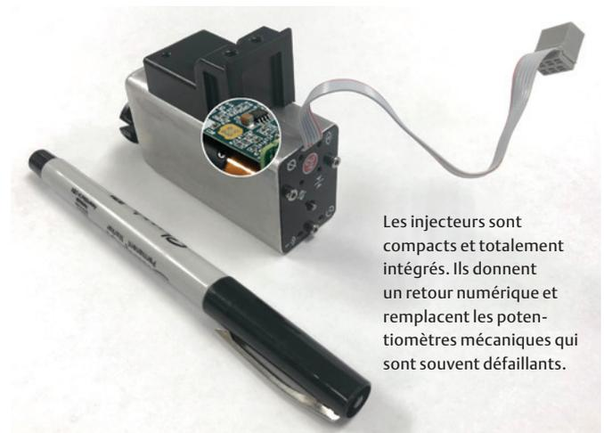
Les injecteurs sont compacts et totalement intégrés. Ils donnent un retour numérique et remplacent les potentiomètres mécaniques qui sont souvent défectueux.
