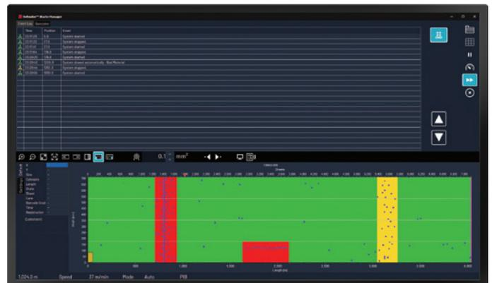
**Defender Waste Manager** si interfaccia con le unità di ribobinatura, sfridatura e taglio di fogli per controllare automaticamente quando si fermano e respingono, consentendo una rimozione semplice e rapida dei materiali difettosi.
